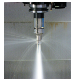
BT40-HA412-M-OHC型 + TC412-MO-M6-3H-SB型 切削液(5MPa)吐出中
